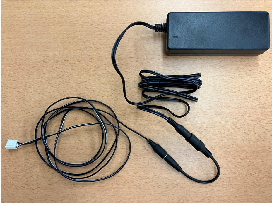
変換ケーブルを介して、図のように接続します。接続する際は、コネクタの向きに注意してください。
