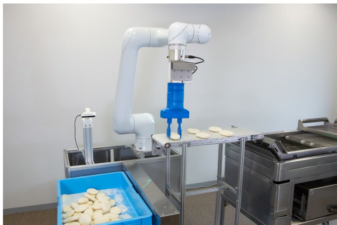
人協働ロボット COBOTTA PRO を使った 冷凍フライ投入システム
