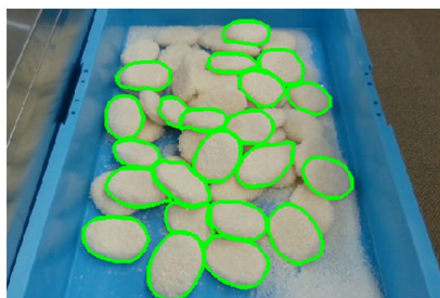
①AIでばら積みの冷凍フライを画像認識 (パン粉があっても認識可能)
