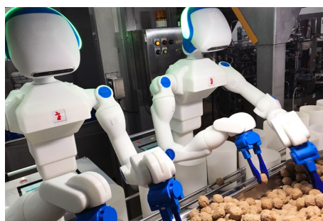
惣菜加工工程でつくね具材を投入する Foodly(イチビキ)
