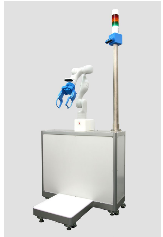
図 2. 実装システム全体の外観例 (Kinova 社 KINOVA Gen3 使用)
