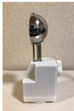
画像 5 計量盛付向けエンドエフェクタ (開発中参考例)
