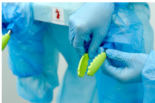
画像 4 サニタリに配慮したトング形状 エンドエフェクタ例
