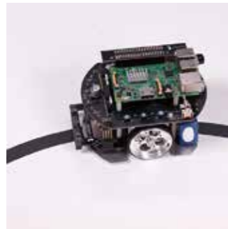
標準搭載の赤外線LEDと測位センサによる自律走行制御をプログラミング
