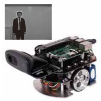
USBカメラと画像認識ソフトOpenCVで人の顔に追従するプログラミング
