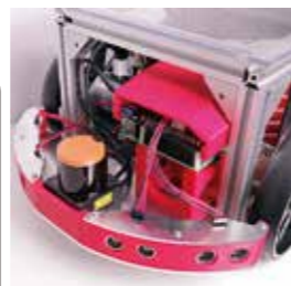
自律移動ロボット用測域センサ車体前部に装着が可能です。
