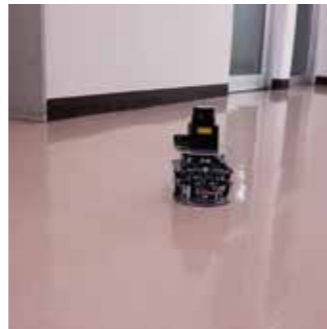
SLAM 測位センサで地図を生成自己位置推定と地図作成を同時に行うプログラミング
