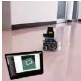
SLAM オプションキットの測位センサで地図を生成自己位置推定と地図作成を同時に行うプログラミングができます。
