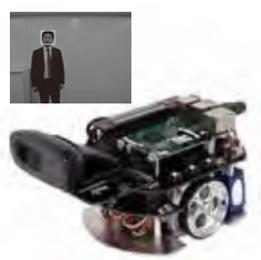
別売のUSBカメラを装着し、画像認識ソフトOpenCVで人の顔に追従するプログラミングができます。
