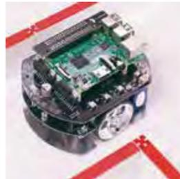
標準搭載の赤外線LEDと測位センサーによる自律走行制御のプログラミングができます。
