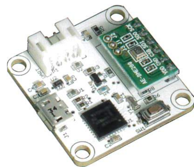
RT-USB-THP USB 温湿気圧センサモジュール
