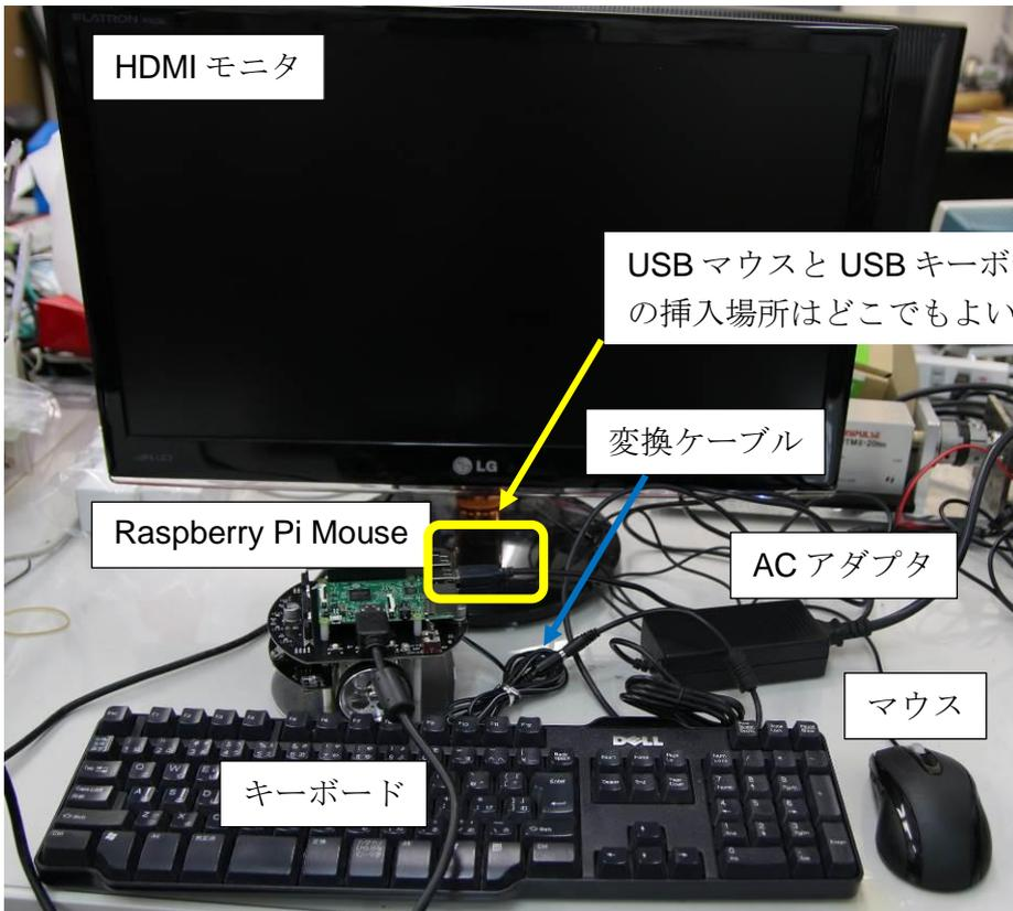
上記の接続例では、電池の代わりに AC アダプタで接続しています。(フルキットに含まれています。Raspberry Pi Mouse 単品で購入し AC アダプタがほしい方は、オプションで別途購入できます。[\(LiPo 充電器 LBC-010\(AC アダプタ・変換ケーブル付き\)7500 円\(税抜\)\)](#))
