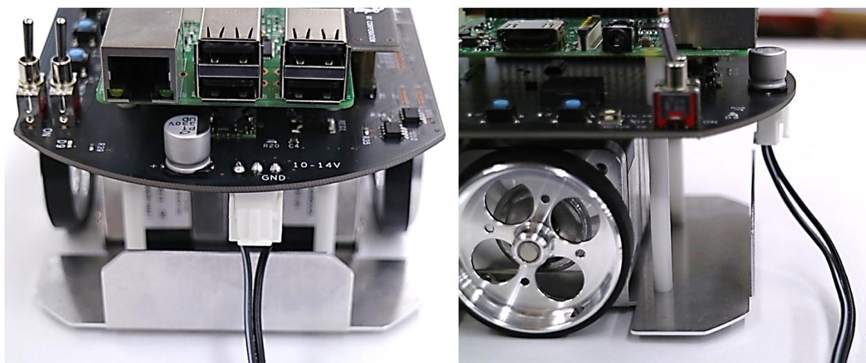
Raspberry Piを単体で使用するとき、USBコネクタから電源供給しますが、Raspberry Pi Mouseは、上記の指定したコネクタ以外からの供給すると故障の原因となります。Raspberry Pi Mouseを組み上げたあとは、**くれぐれもRaspberry Piの電源供給ポートから電源を供給しないでください。**
