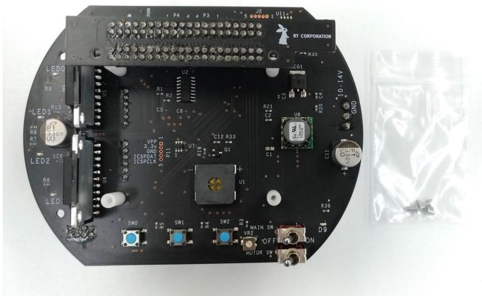
Raspberry Piをつなぐコネクタを外し、スペーサーの上にRaspberry Piを置き、Raspberry Piを置いたら、同梱されているネジで固定してください。
