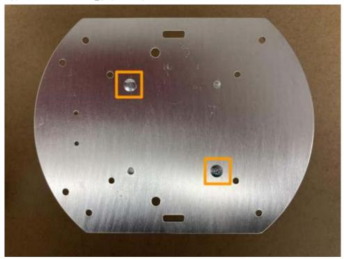
8. 低頭ネジM2.6-5(FLA-2605E)でフレームをスペーサに固定します。画像のように固定すると、Raspberry Pi Mouseの前方(ライトセンサ側)にURGの前面が向きます。
